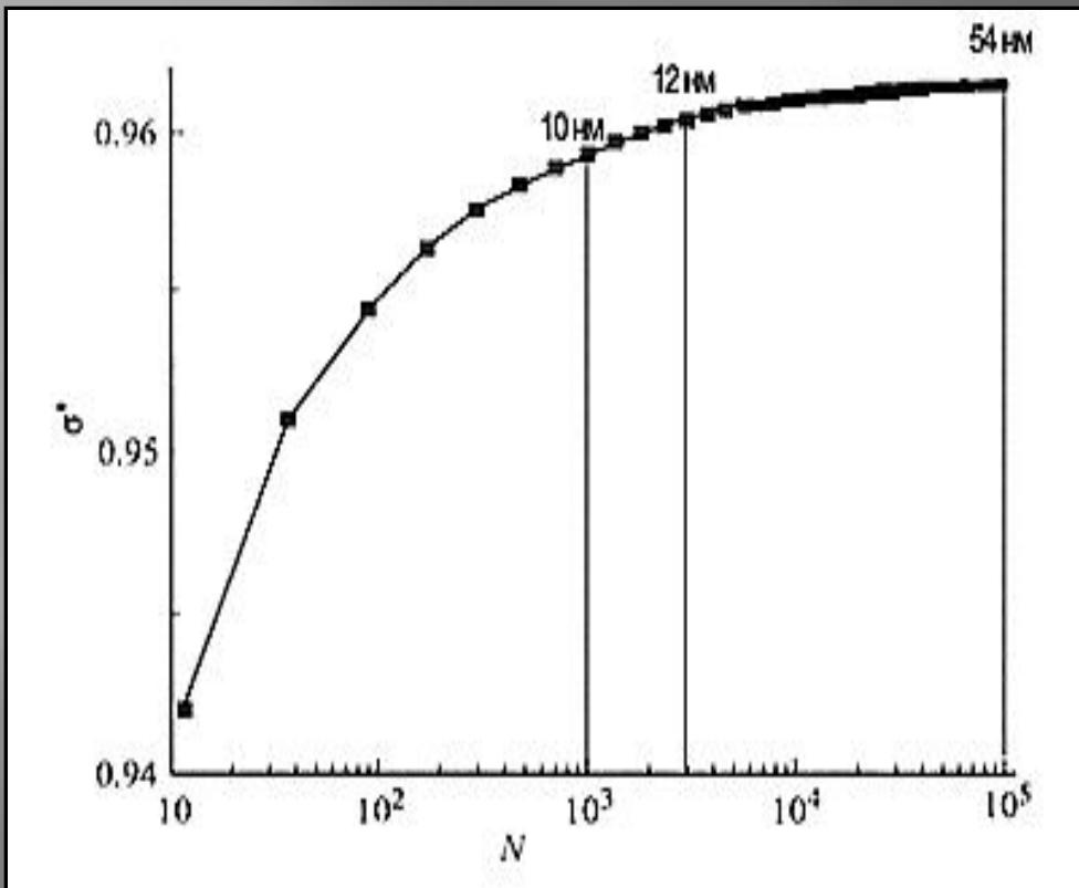
*Зависимость относительного значения поверхности свободной энергии от числа атомов нанокристалла*
