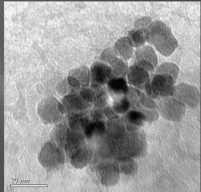
**Изображения синтезированных порошков диоксида циркония, сделанные с помощью просвечивающей электронной микроскопии**
