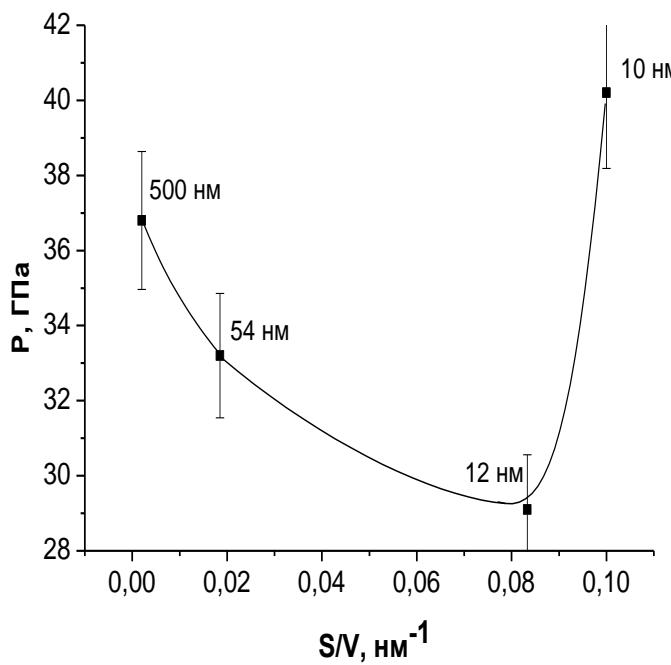
Экспериментальные данные по влиянию размеров зерна на фазовые переходы при высоких давлениях свидетельствуют о зависимости давления перехода от размеров кристаллитов. Это связано с возрастающим вкладом поверхностной энергии межзеренных границ в полную энергию кристалла при уменьшении размера частиц .
