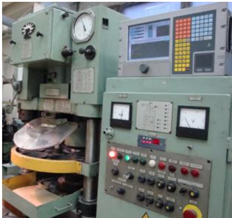
гидравлический пресс ДО138 с усилием 630Тс
