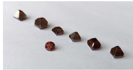
Рисунок 2. Фото облученных электронами алмазов (а) и отожженных при 900 °С в течение 2 часов (б)
